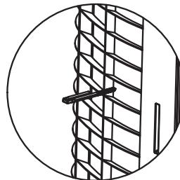
Utilizando pinzas, retire las clavijas del exterior.
