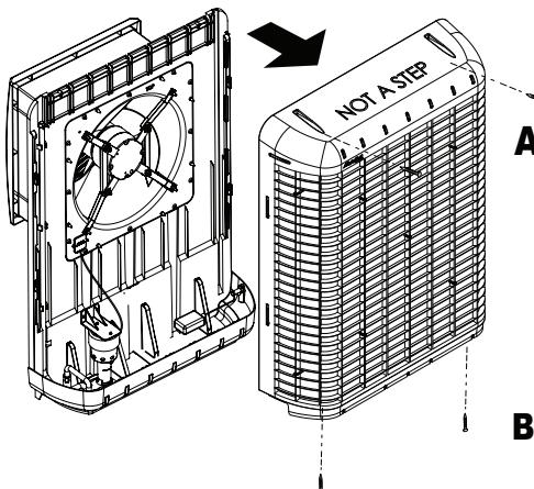
A. Retire los 4 tornillos de la parte trasera de la unidad
