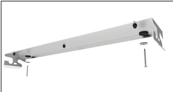
**1** À l'aide de la vis avec rondelle, montez le support de montage à travers l'isolant en caoutchouc. Assurez-vous que le support est droit.
