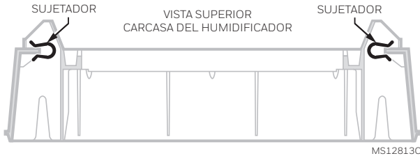
Fig. 4. Colocación de los sujetadores de fijación.
