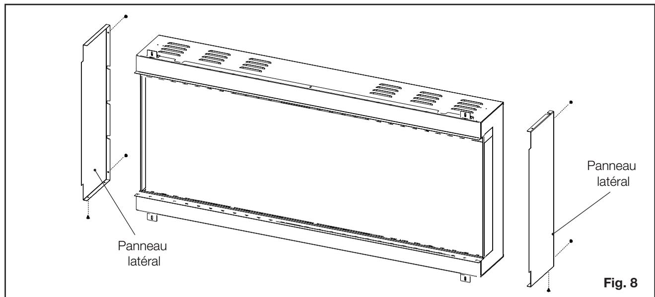
Dans le cas d'une enceinte murale d'extrémité à 2 côtés (avant et 1 côté), installez les garnitures supérieure et inférieure ainsi qu'un panneau en forme de C et un panneau plat sur le côté respecté qui doit être ouvert et fermé.
