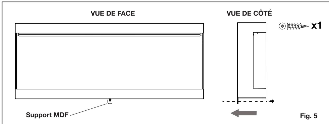
7. Une fois le support MDF fixé à l'appareil, fixez le support MDF au mur à l'aide d'une vis (**Fig. 5**).
