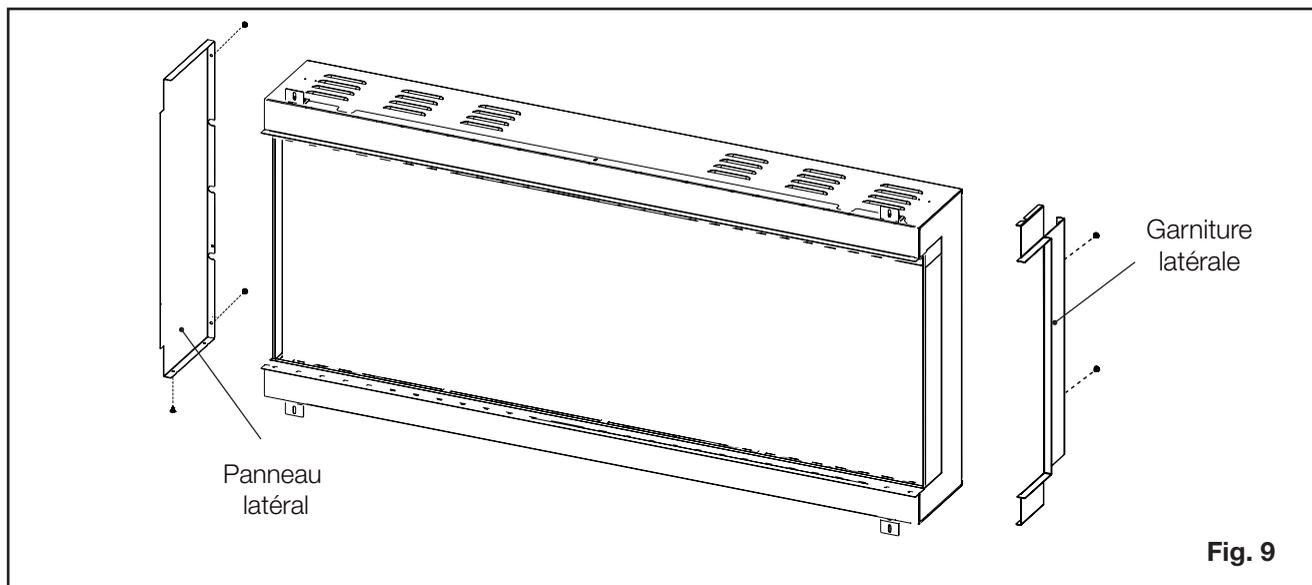
4. Fixez les deux garnitures latérales en retirant les vis de l'arrière du foyer qui s'alignent avec la garniture la garniture, puis fixez la garniture à l'aide des vis à métaux fournies. **(Fig. 10).**
