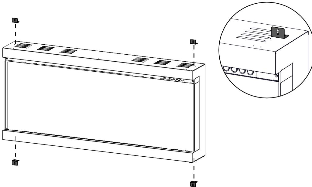
5. Insérez l'appareil dans l'ossature brute en fixant les vis (fournies) à travers les trous fendus de chaque support de fixation de l'appareil dans l'ossature brute. **(Fig. 7).**
