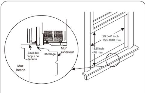
3. Toutes les pièces de support doivent être fixées à du bois solide, de la maçonnerie ou du métal.
