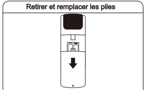
Utilisez un petit tournevis cruciforme pour desserrer le vis du couvercle de la batterie. Faites glisser le couvercle de la batterie vers le bas avec deux pouces pour le retirer. Retirez et éliminez correctement les anciennes piles, puis remplacez-les par deux nouvelles piles AAA. Remplacez le couvercle de la batterie et serrez la vis.
