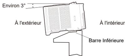
**NOTE:** Le climatiseur doit être incliné d'environ 3° pour permettre un meilleur drainage de la condensation et de l'eau de pluie. À l'aide d'un niveau, mesurez environ 1/3 de bulle pour obtenir la pente correcte.
