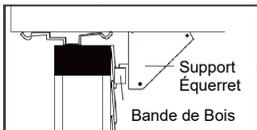
5. Vissez l'armoire sur le cadre en bois en utilisant des cales comme indiqué ci-dessous avec 7 longues vis à tête hexagonale, n'oubliez pas de maintenir une pente appropriée pour l'élimination de l'eau.
