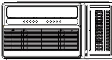
Poussez le châssis dans l'armoire. Réinstallez les vis de l'armoire, et rattachiez la façade avant, le panneau avant et le filtre à air.
