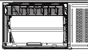
Retirez les 2 vis fixées sur les côtés gauche et droit du boîtier et du châssis
