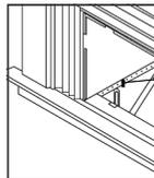
Boulon à tête plate de 1/2" de long et écrou de blocage
