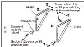
2. Assemblez les supports d'angle du seuil aux supports de fixation à la position marquée comme indiqué ci-dessus. Serrez à la main, mais pas complètement pour d'éventuels ajustements nécessaires ultérieurement pendant l'installation.
